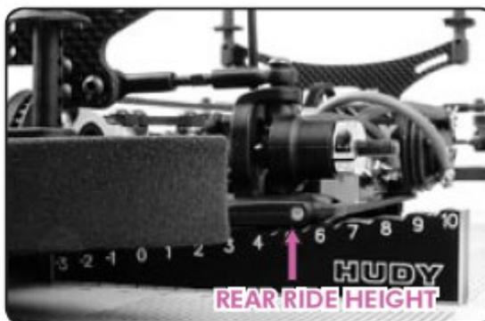
Il Downstops limita la corsa verso il basso dei bracci delle sospensioni, il che determina quanto verso l'alto risale il telaio. Questo influenza il comportamento della vettura (a causa di effetti sul camber e sul centro di rollio) e la capacità del pneumatico di "seguire" il tracciato. Gli effetti possono variare con il tipo di pista e/o la quantità di grip a disposizione.
