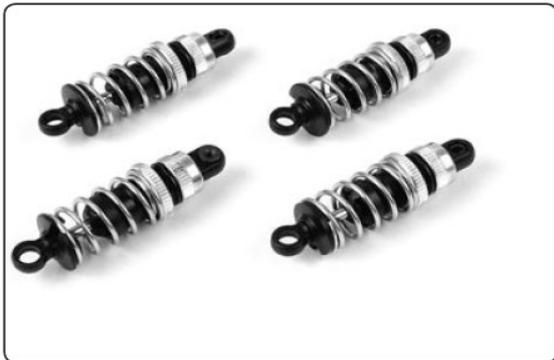
Gli Ammortizzatori, sono i componenti delle sospensioni che permettono alle ruote di mantenere il contatto il più possibile con il suolo. La XRAY T3 ha sospensioni totalmente indipendenti fra anteriore e posteriore, il che significa che la sospensione in ogni angolo dell'auto (anteriore sinistro, anteriore destro, posteriore sinistro, posteriore destro), si muove e può essere regolata indipendentemente dalle altre. Infatti c'è un ammortizzatore ad ogni angolo dell'auto.
