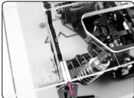
5. Per leggere il valore di Toe della ruota posteriore sinistra, spingere il toe gauge verso destra finché il perno sul bordo superiore sinistro del set-up stand colpisce il bordo della fessura del Toe gauge
