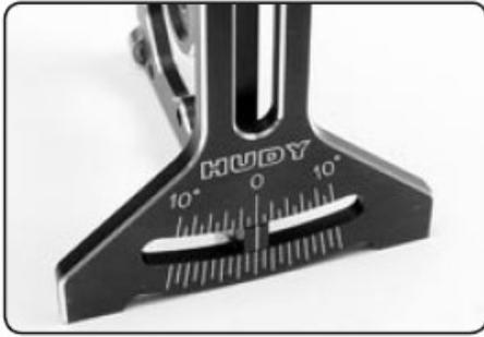
Ogni segno indica un grado di valore di camber. Dovrai essere bravo a settare il camber con una tolleranza di 0.5 gradi.
