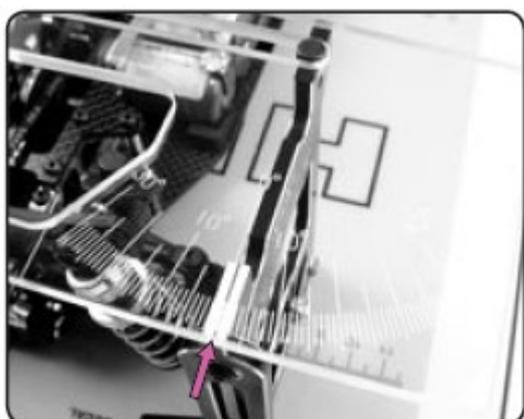
Per leggere il valore di Toe della ruota posteriore destra, spingere il Toe gauge verso sinistra finché il perno sul bordo superiore destro del set-up stand colpisce il bordo della fessura del Toe gauge. Ora leggi la misurazione.
